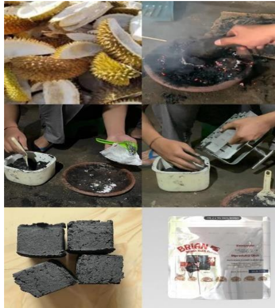
Gambar 2. Proses Pembuatan briket dari awal hingga pengemasan
